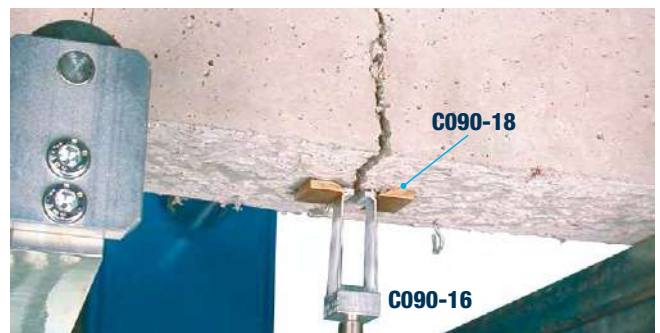
EN 14651 Clip gauge device
